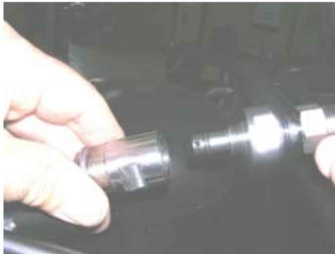
Figuur 6 – Verwijdering los deel veiligheidsklep
